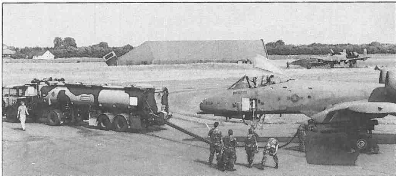
Der refuel'es i NE-området. Tankningsproceduren overvåges af to teknikere, hvor den ene står klar med slangen fra halonlukkeren og den anden er klar til at åbne for halonen. (foto s-n).
