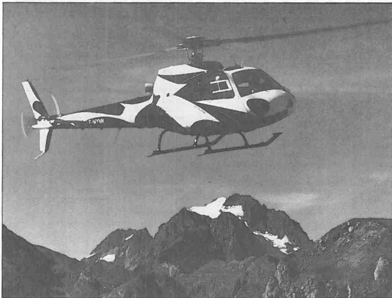
AS350 B1 Ecureuil civil udgave med lavt understel.
