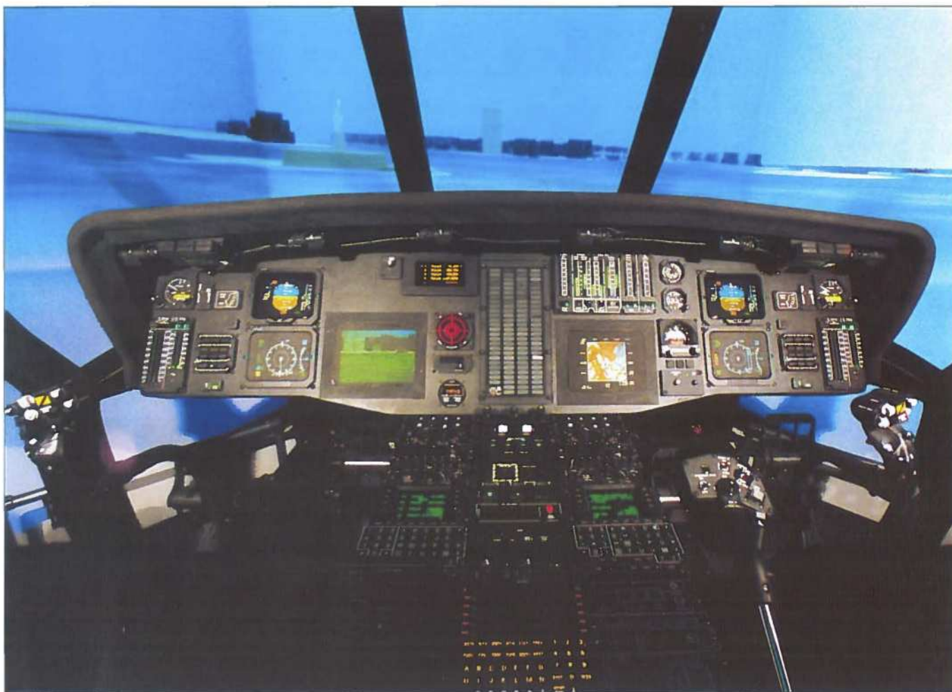
Alle Sikorsky helikoptere kan udstyres med et glascockpit magen til det viste. Det viste layout indeholder AFCS system, automatiseret flight computer og EFIS, et elektronisk flight information system, som forsyner piloten og navigatøren med alle nødvendige oplysninger under flyvningen. Hvor meget udstyr der skal i cockpittet er her, som i alle andre tilfælde et spørgsmål om to ting: Vægt og penge. (Foto Sikorsky).
