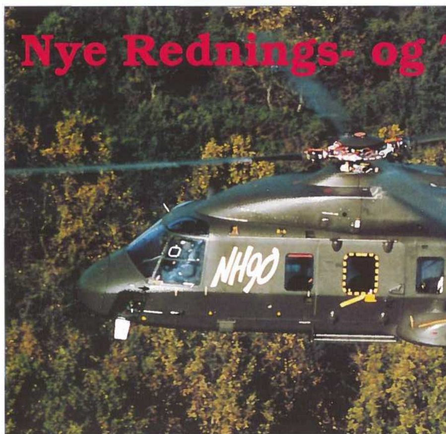
▲ NHIndustries nye NH90 helikopter, som findes i to versioner, NH90 TTH (Tactical Transport Helicopter) og NH90 NFH (Naval Frigate Helicopter). Begge kan ifølge firmaets oplysninger anvendes til eftersøgnings- og redningstjeneste (SAR) og til COMBAT SAR, redning af pilot og/eller besætningsmedlemmer under kampforhold. (Foto K. Tokunaga for NHIndustries)
