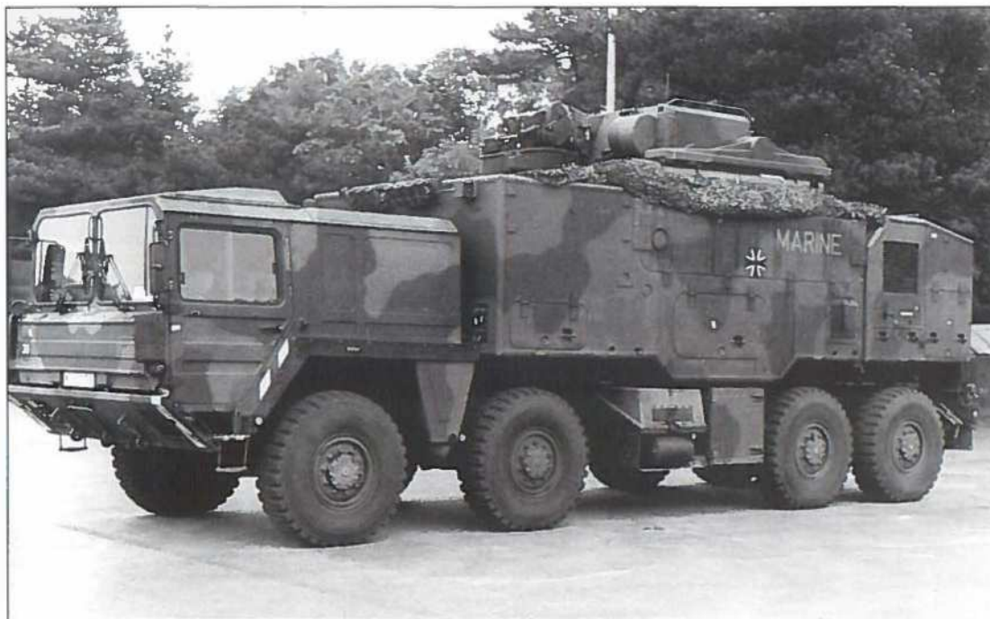
Et komplet nærluftforsvarssystem bygget ind i et køretøj og på tysk benævnt, Flugabwehr Gefechtsstand ROLAND. Lidt overraskende står der MARINE på køretøjet, og det tilhører da også Naval Air Wing 2, Fliegerhorst. (Flyvestation) Tarp ved Flensburg.
