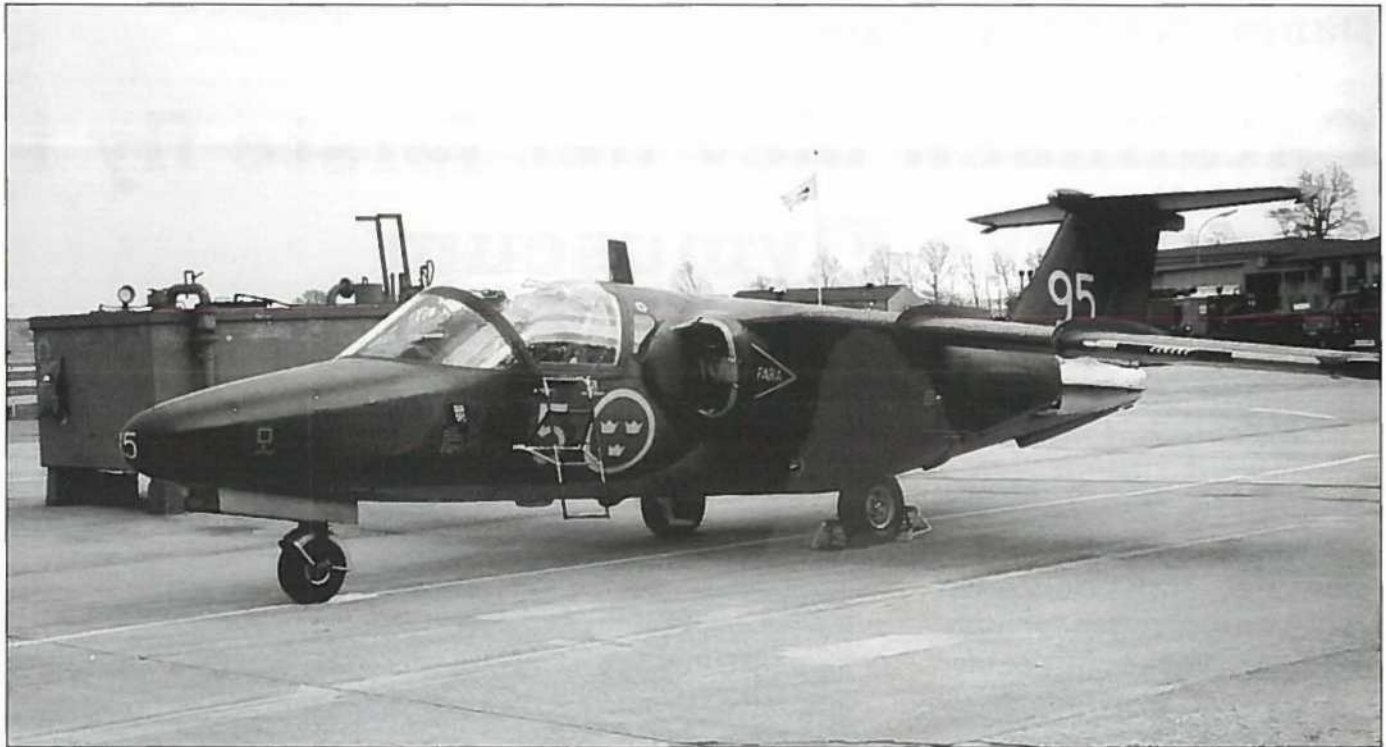
Skolflygplan SK 60, er den militære udgave af SAABs 105, som i et antal af 150 kom i tjeneste ved Flygvapnet i 1966. Flyets gamle Turboméca-Aubisque motorer, med den svenske betegnelse RM 9, er under udskiftning med to Williams-Rolls FJ 44-1C, svensk betegnelse RM 15-motorer. Se i øvrigt FLYNYT nr. 1/97 side 61.
