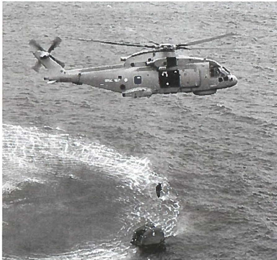
Hoist fra en overdækket gummibåd. Læg mærke til, hvorledes vandet piskes op af downwash, som i dette tilfælde ligger en smule skråt bagud til venstre for helikopteren. Inde i cirkelens midte er der forholdsvis vindstille.
