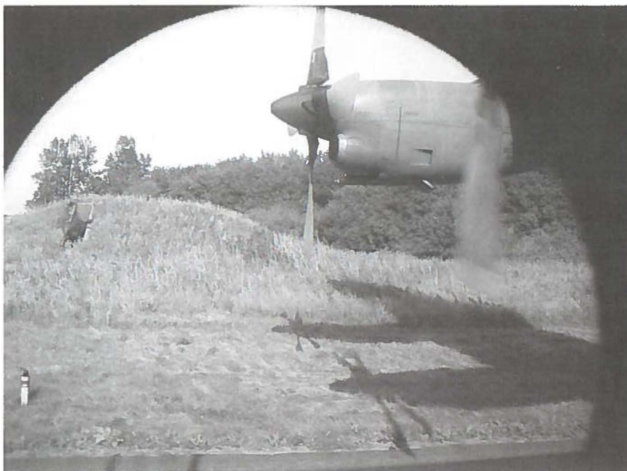
Set gennem „køjet under taxi” kunne være titlen på dette billede. Vi er tilbage på flyvestation Aalborg og taxi’er tilbage til eskadrilleområdet. Piloten stopper yderste styrbords motor, medens inderste motor leverer trækraften, der skal til for at nå ind.
