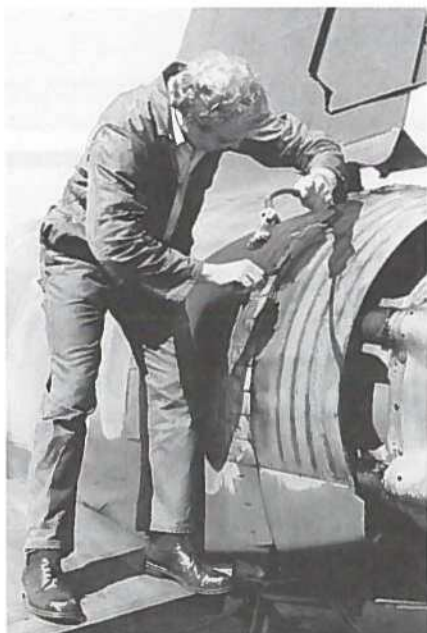
Dengang i 1980, medens der stadig blev fløjet med F-100, var flyveroverkonstabel H.J. Absalon beskæftiget med at „gemme“ kablet til „dragshuten“ (bremsefaldskærmen).
