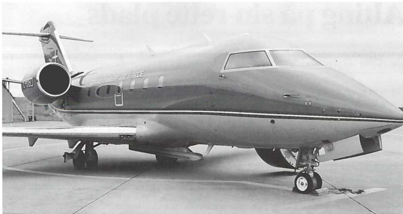
'hallenges 604 flyet, der skal gennemføre overvågningen af havoverfladen fra luften. Under flyets bug ses den omtalte Side Looking Radar (SLAR) (Radar, der kan se mellem 20 og 35 km ud til siderne). (Billede J.E. Rasmussen, Fototjenesten, Flyvestation Værlose).
