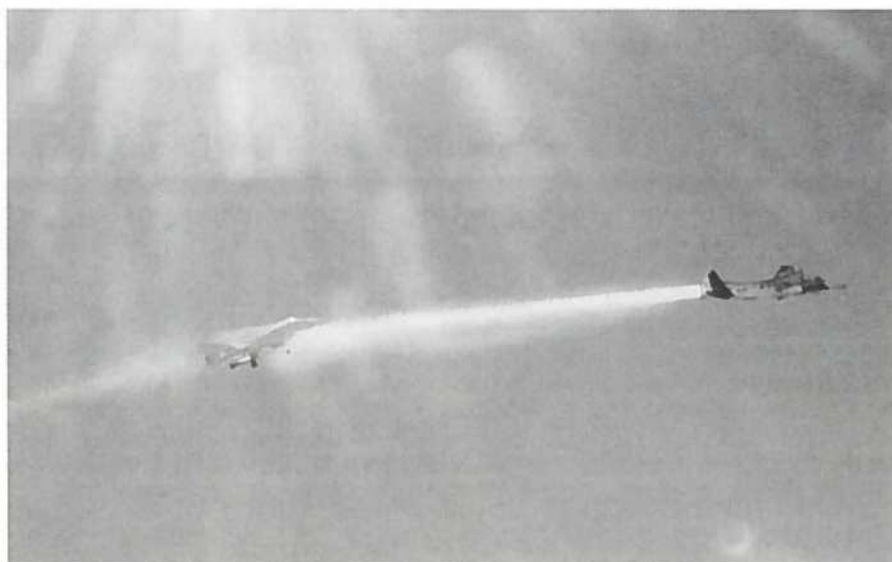
En Eurofighter Typhoon på vej ind i skyen af underafkølet nedbør som skabes ved at en Fairchild/Donier Do228 lukker vand ud gennem en dyse ude agter.
