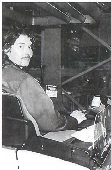
Truckfører Jess V. Hansen på sin moderne gaffeltruck. Han kan se fjernsyn hele dagen. Programmet der vises er, hvor gaflerne på trucken befinder sig i forhold til hylderne.
