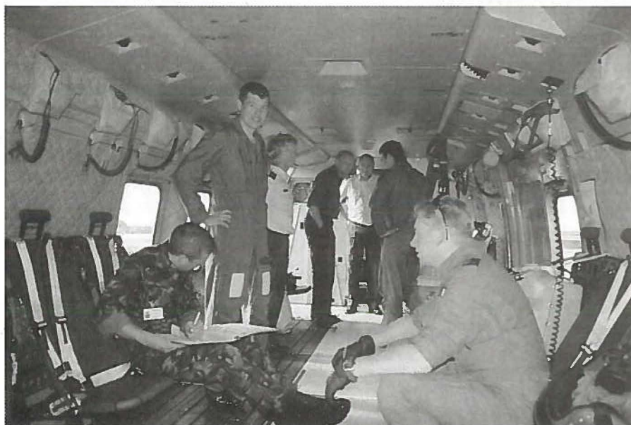
Et kig ind i kabinen fortæller, at her er masser af plads. På sæderne, der er crashworthy, det vil sige sikrede mod at bryde sammen ved et havari/hård landing, er der plads til 30 soldater.
