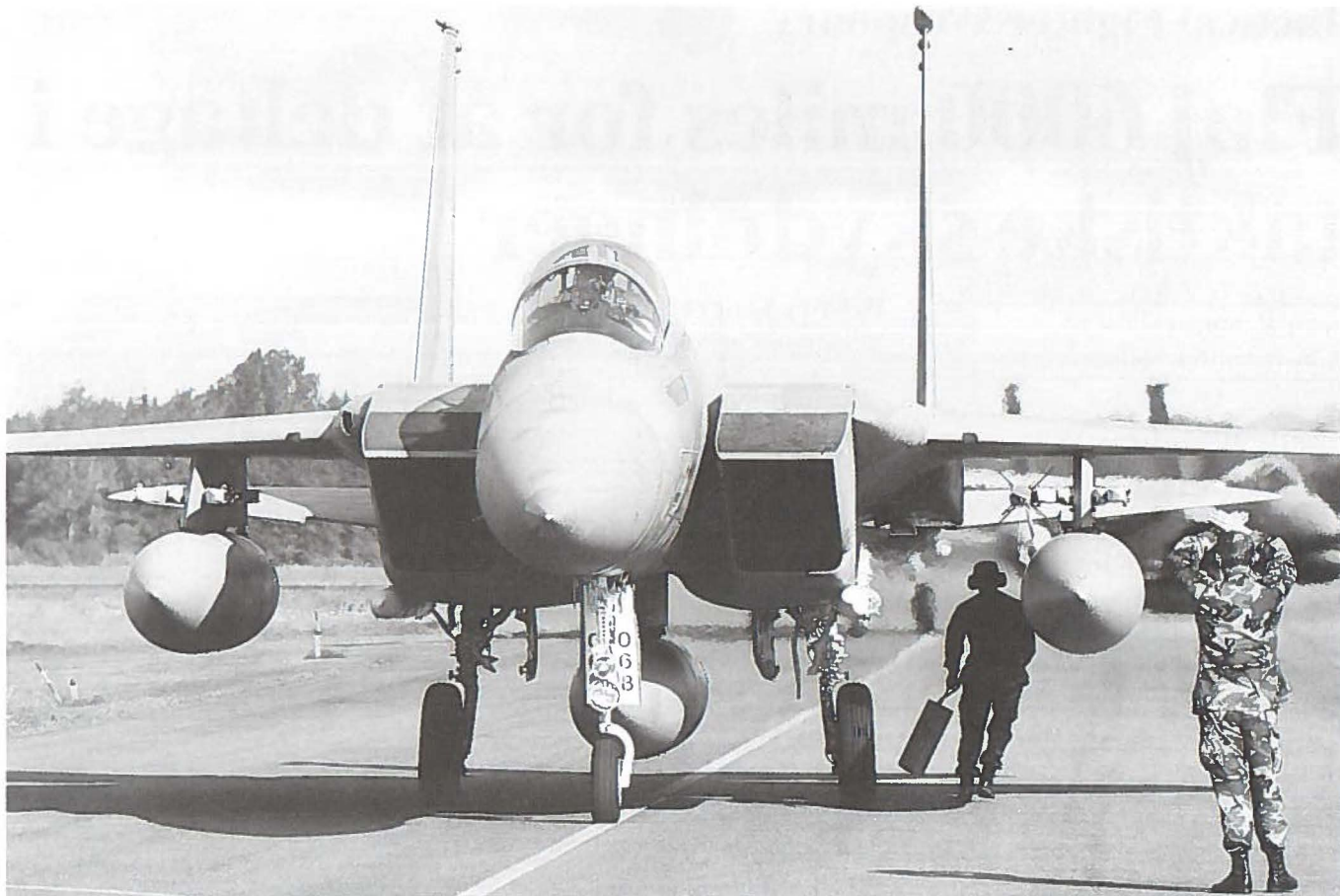
Så er sikringsspindene fjernet, klodserne fjernes fra hovedhjulene, og man kan rulle ud til start. Under indsugningen sidder et AMRAAM, mellemdistance luft-til-luft missil, og oppe under vingen et AIM-9L Sidewinder korttrækkende luft-til-luft missil. (Billede, Fototjenesten, Flyvestation Aalborg).
