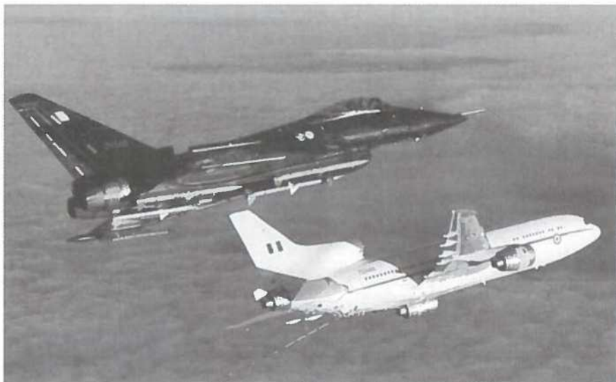
Udviklingsfly nr. 2 (DA2), som er blevet malet sort, på vej ind for at gennemføre Air Refuelling (lufttankning) hos en Royal Air Force Tristar KC1 tanker fra No 216 Squadron på RAF Brize Norton.
