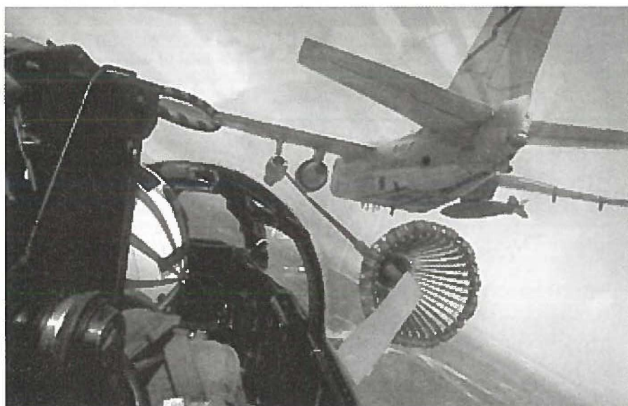
Lockheed Martins hangarskibsbaseerede S-3 Viking. Flyet er konstrueret til jagt på ubåde, men kan forsynes med en tank, D-704, hvorefter den kan lufttanke andre fly ved hjælp af slange med kurv og studs. (Billede Lockheed Martin).
