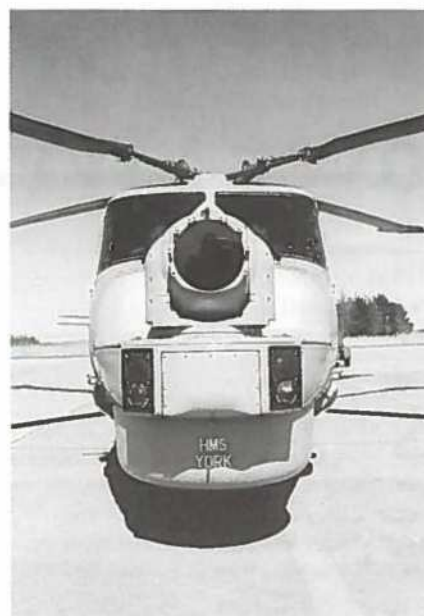
En Royal Navy Lynx, til dagligt hjemmehørende på Her Mastesty's Ship York. Inde bag den runde glasrude gemmer sig de sensorer, som helikopterens besætning bruger til at sigte med, når et overfladeskib skal sænkes.
