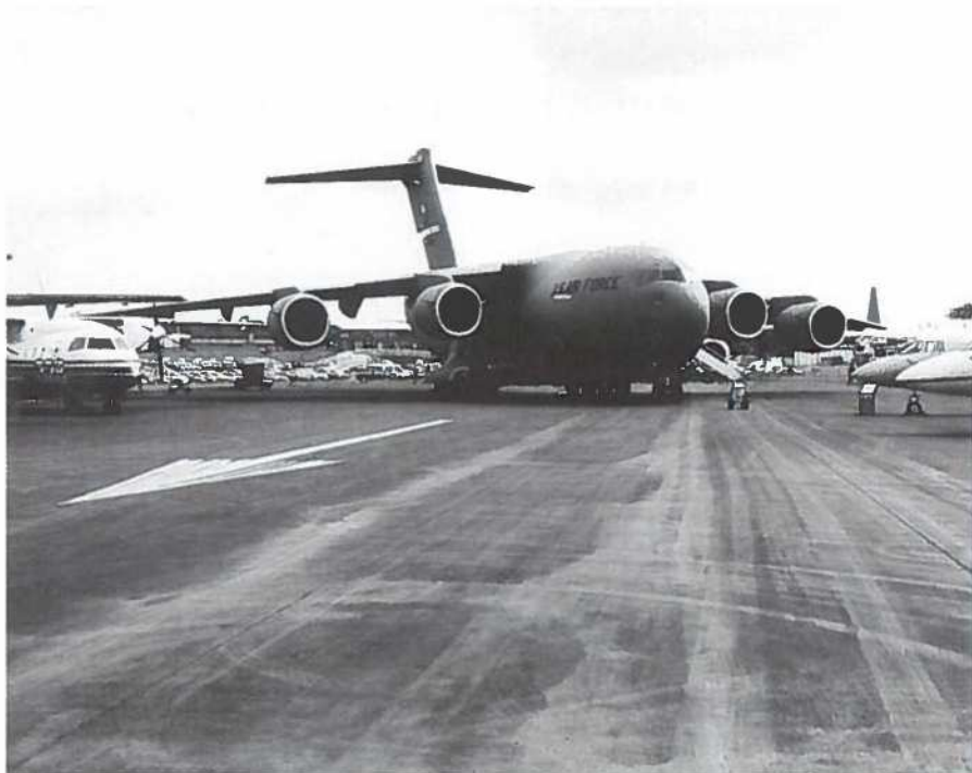
Sådan en Boeing C-17 Globemaster III kan medtage enten en Challenger kampvogn, tre Warrior pansrede mandskabsvogne eller tre WAH-64 Apache kamphelikoptere eller 13 Land Rovers.
