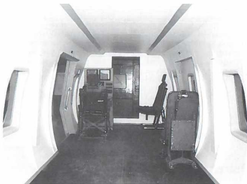
NHIndustries har haft en Mock Up stående i Danmark i godt en måneds tid. Billedet viser kabinen indvendig, hvor „ståhøjden“ nu er øget til 1,83 m. Sidst har den stået hos Danish Aerotech på Flyvestation Karup som planlægger at fremstille paletter til de moduler, der skal kunne rulles ind og ud af helikopteren.
