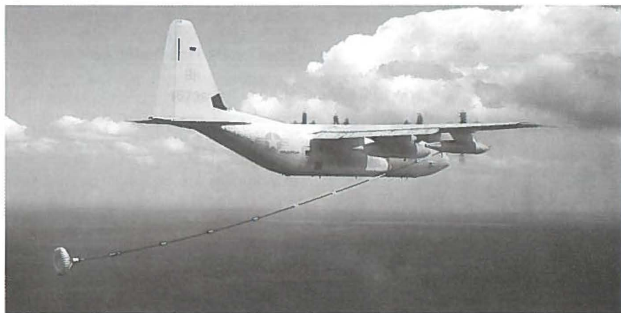
Lockheed Martins seneste levering til US Marine Corps, en KC-130-J Hercules Tanker, som kan tanke både fastvingede hurtige fly og helikoptere.
