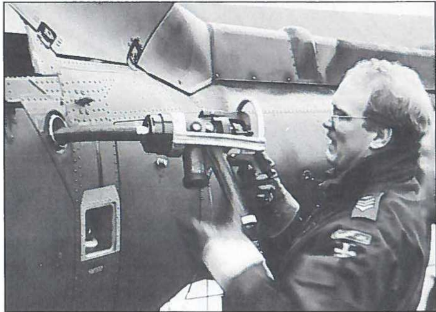
På billedet viser flyveroverkonstabel og flymekaniker J.B. Graverson, hvorledes single point head føres ned til tankstuds. Bøjlen over hans højre hånd drejes til højre og single point head er låst fast på tankstuds. Ved hans venstre hånd ses røret, som udluftningsslangen monteres på.
