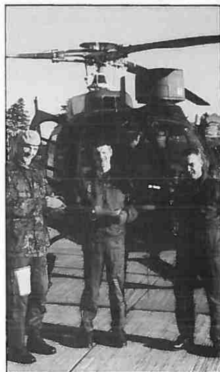
Man er nu klar til at gennemføre en Rotor Running Refuelling (RRR) på Fennec'en. Bemærk udluftningsslangen, som løber parallelt med brændstofslangen.
