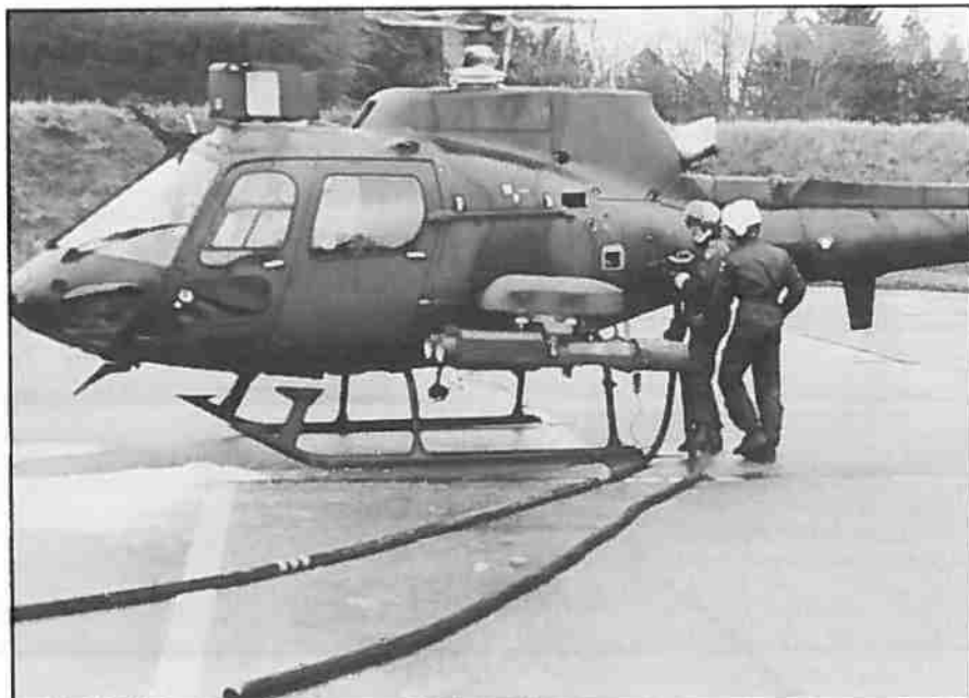
Man er nu klar til at gennemføre en Rotor Running Refuelling (RRR) på Fennec'en. Bemærk udluftningsslangen, som løber parallelt med brændstofslangen.
