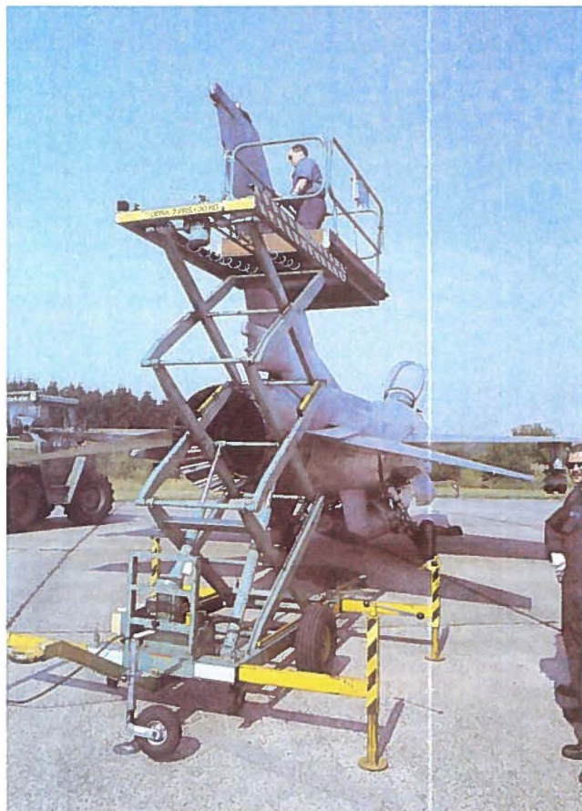
Stillads måtte der til flyveroverkonstabel S. Barfod skulle skifte antenntæppen på en F-16. Den sidder trods alt fem meter over jorden. Og så er arbejdssikkerhed ikke noget man spøger med.
