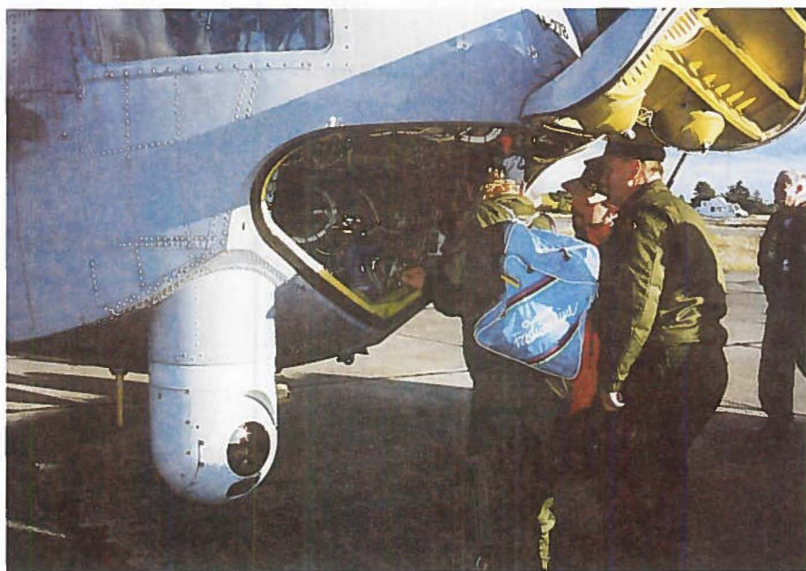
En S-61 med næsen åbnet. Nederst til venstre ses FLIR (Forward Looking Infrared)-senderen. Inde i gabet genmer sig al teknikken, som tiltrak sig især teknikernes opmærksomhed.
