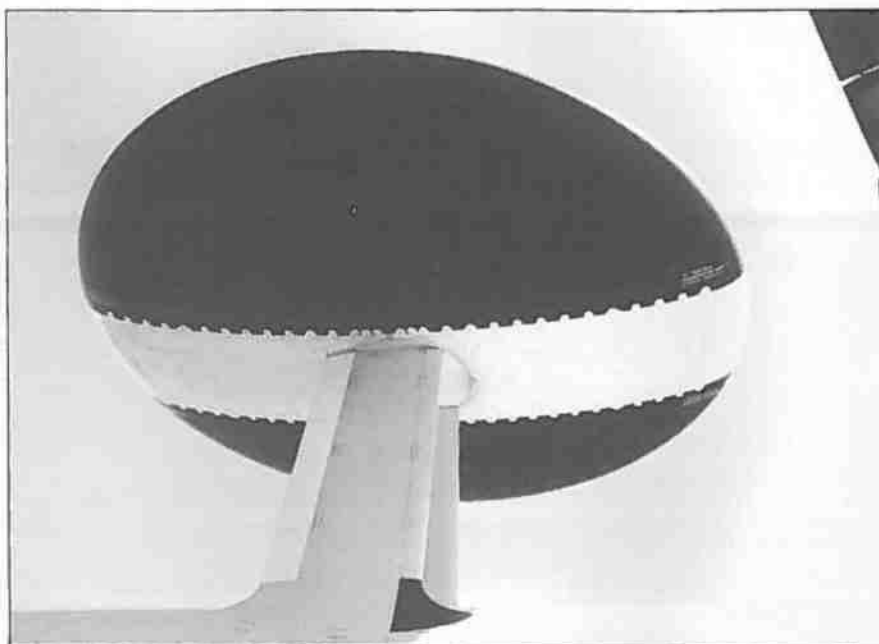
En næroptagelse af radomen, hvor en almindelig radar og en sekundær radar (IFF) er monteret med ryggen til hinanden bag hver sin sorte radomehalvdel.
