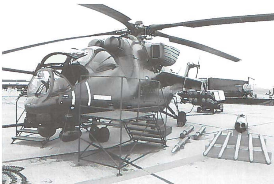
Rostvertol Mi-35M i den næsten klassiske russiske opbygning med de stumpe vinger til at bære våbensystemet og samtidig være med til at yde en smule opdrift. Th. for helikopteren ses pod'en med plads til de fire 122 mm S-13 raketter.
