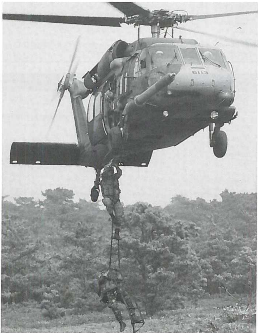
UH-60L Pawe Hawk her i Combat Search and Rescue og Special Operations versionen. Den kan refueles i luften og har 7,52 mm og 50" maskingevæber om bord til selvforsvar. Til brug under Special Operations har den et „Fast Rope System“, det vil sige kampsoldater kan landsættes medens helikopteren hover (svæver) over landsætningsområdet. (Billede Sikorsky).
