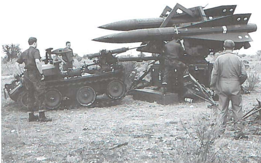
Også Eskadrille 543IRF var med på øvelsen på Flyvestation Amendola. Her demonstreres opladning af en launcher (afskydningsrampe). (Billede s-n).
