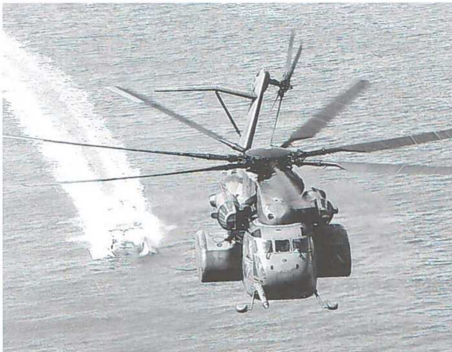
Sikorsky's CH-53 Super Stallion kan medføre 13,6 t last i lastrummet, hvis der er tale om hængende last i sling kan den medtage 14 t. (Billede Sikorsky).
