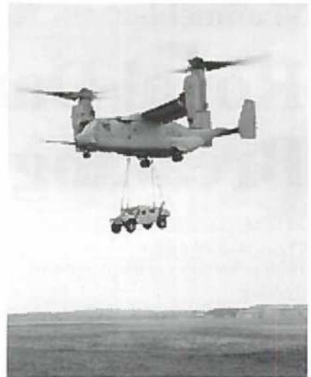
En Boeing V-22 Osprey på Patuxent River Naval Air Station i færd med at transportere en 2.948 kg tung HM-WWV i sling. (Billede Boeing).
