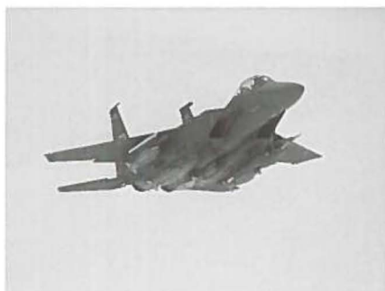
Boeing F-15 E Eagle med fem stk. JDAM (Joint Direct Attack Munition) (bombe der styres ved hjælp af GPS eller TN) på stationerne under flyet.
