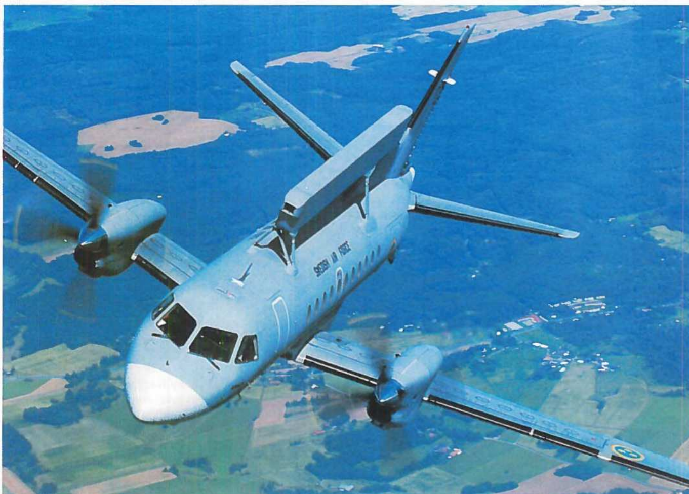
Saab's 100B Argus med den kantede antenne på ryggen. Antennen dækker to gange 120° og ud til en afstand på ca. 300 km. Lige nu er der ikke operatører med i flyet, men de synes at være på vej. (Billede Peter Liander).
