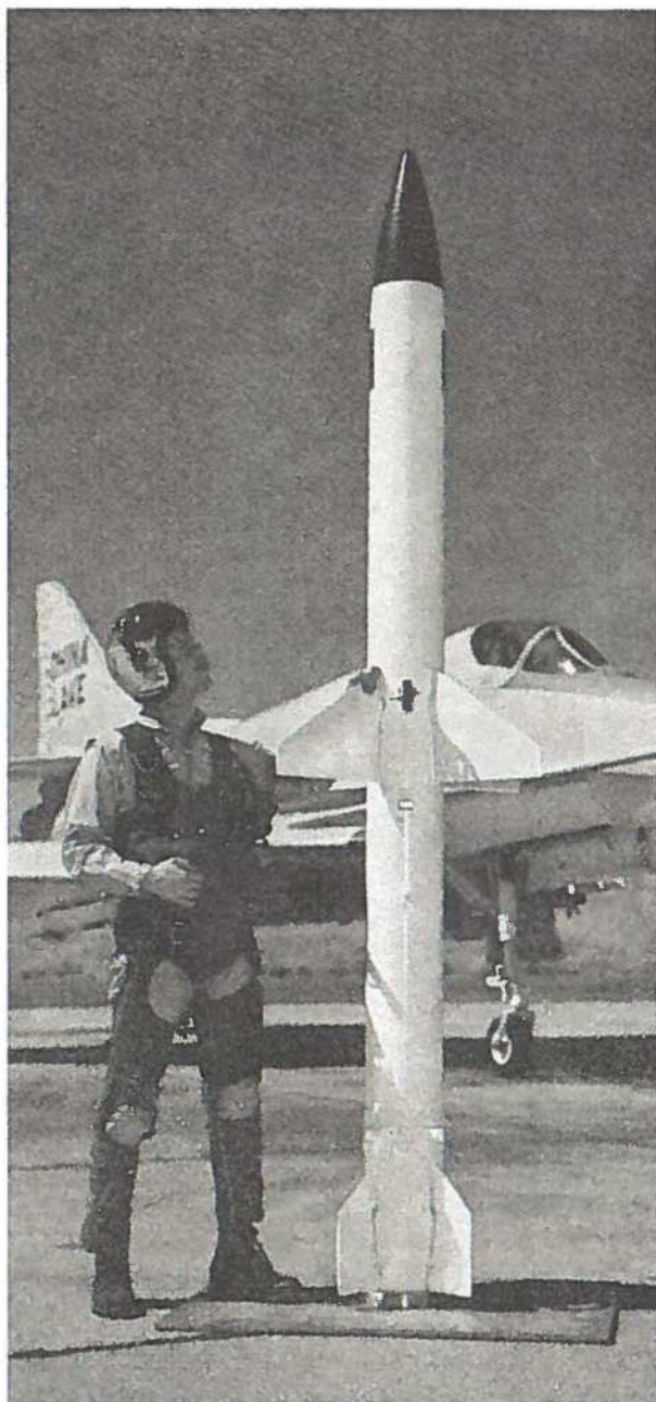
SHRIKE, det første operationelle anti-radar missil (ARM) i den vestlige verden. I baggrunden et A-4 SKYHAWK jagerbombefly, der anvendes til fremføring af missilet. Forbedrede ARM-typer vidnes at være nær operationel status i US, Storbritannien og Frankrig.
