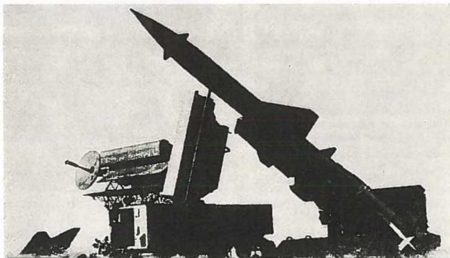
SA-2 GUIDELINE luftværnsraket og FAN SONG ildlederadar. Ildlederadarens vandrette og lodrette trug-antennener, der på fig. er eleveret noget, danner tilsammen målfølgesystemet (TTR), mens parabolantennens funktion er at udsende styreordrer til raketens kommandostyresystem.
